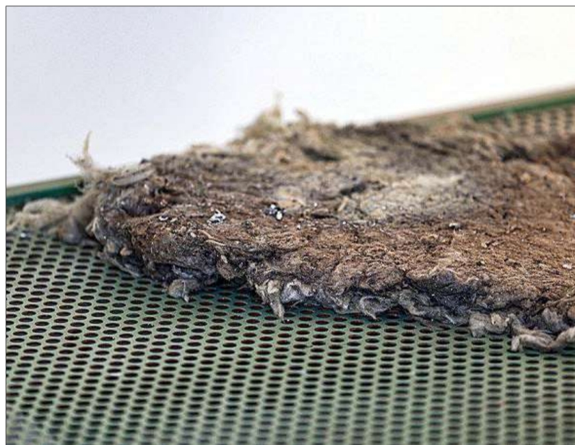
Material calcinado desprendido de la fachada. DAVID GONZÁLEZ / ARABA PRESS
